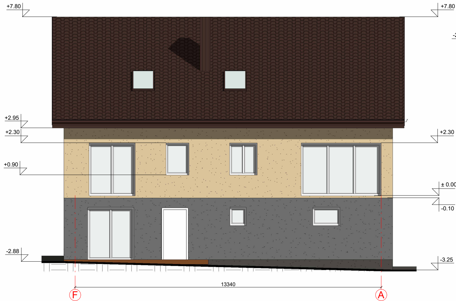
FASADAS TARP AŠIŲ F-A M 1:100
