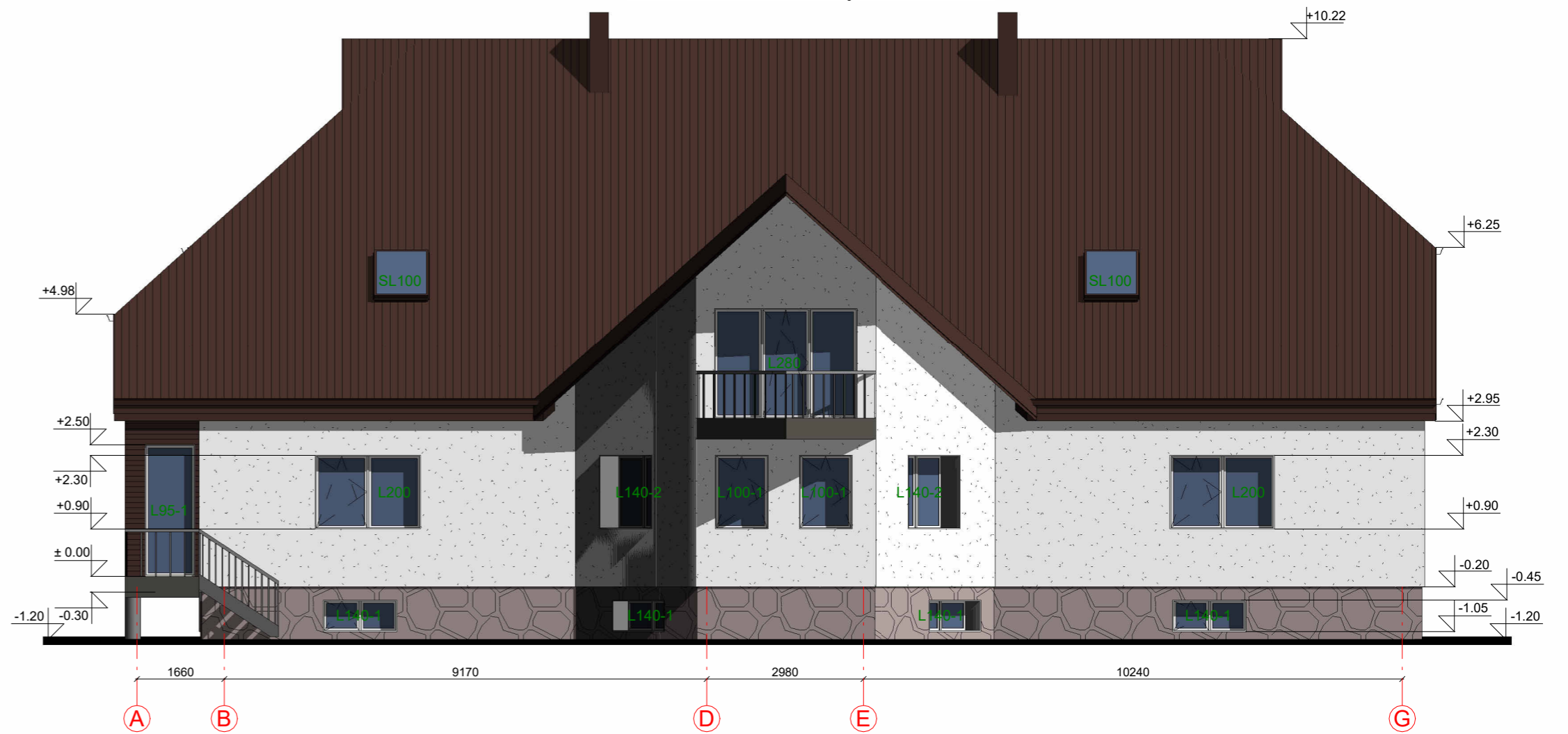
FASADAS TARP AŠIŲ A-G M1:100
